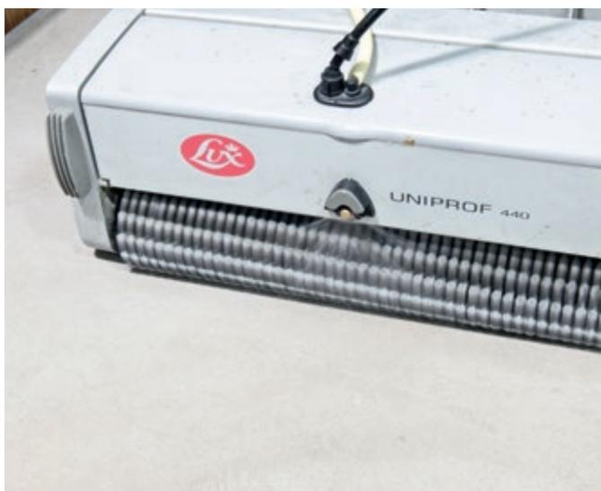
*La pulizia deve essere effettuata in modo uniforme, in sezioni rette. Si prega di seguire le istruzioni fornite dal produttore della macchina per pavimenti.*
